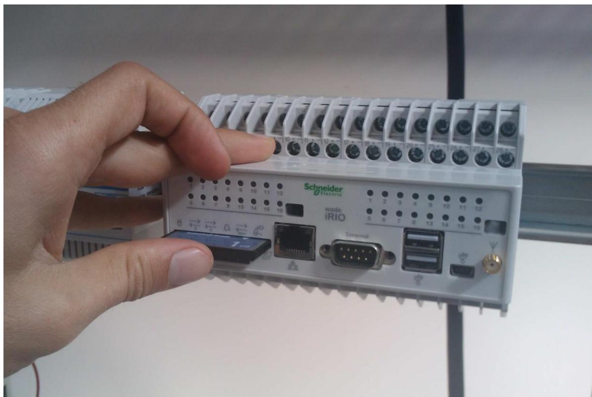
6 – brancher un câble RJ45 entre l'UC et le PC portable avec lequel le programme sera chargé et réalimenter électriquement l'UC
