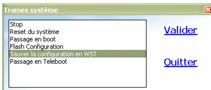
Aller dans « Maintenance/trames système/reset du système ».
